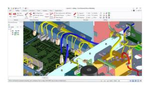
B SpaceCable предусмотрена стандартная проверка того, правильно ли были заданы провода, соединения и кабели. Благодаря этим проверкам проблемы выявляются до отправки на производство. Автоматически разрабатываются отчеты о продукции, как, например, ведомость материалов или таблицы монтажных соединений. Пользователь также может самостоятельно настроить их под свои нужды.
